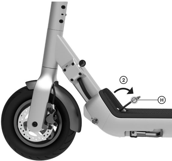
3. Siga empujando la palanca de plegado (H) hacia el estribo, hasta que el patinete se pliegue. Para ello, sujete el kick scooter por el tubo de la columna de dirección y, si es necesario, empuje el manillar un poco hacia delante.
